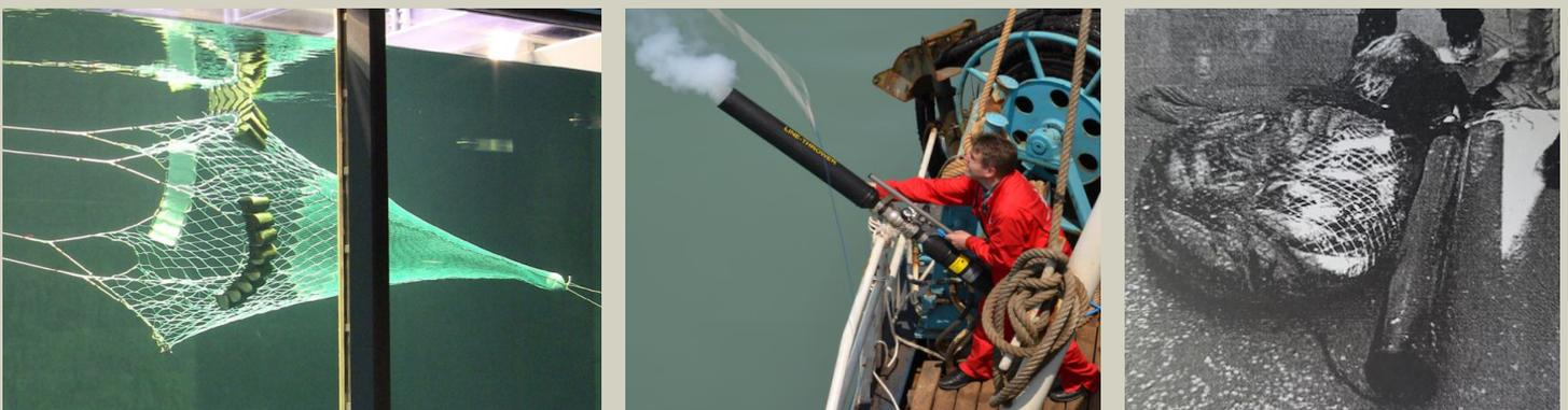
Figura 5. Red cónica para muestreo del cardumen *in situ* y cañón de aire comprimido para su despliegue (ilustración tomada con permiso de los autores Breen, *et al.* 2012).
